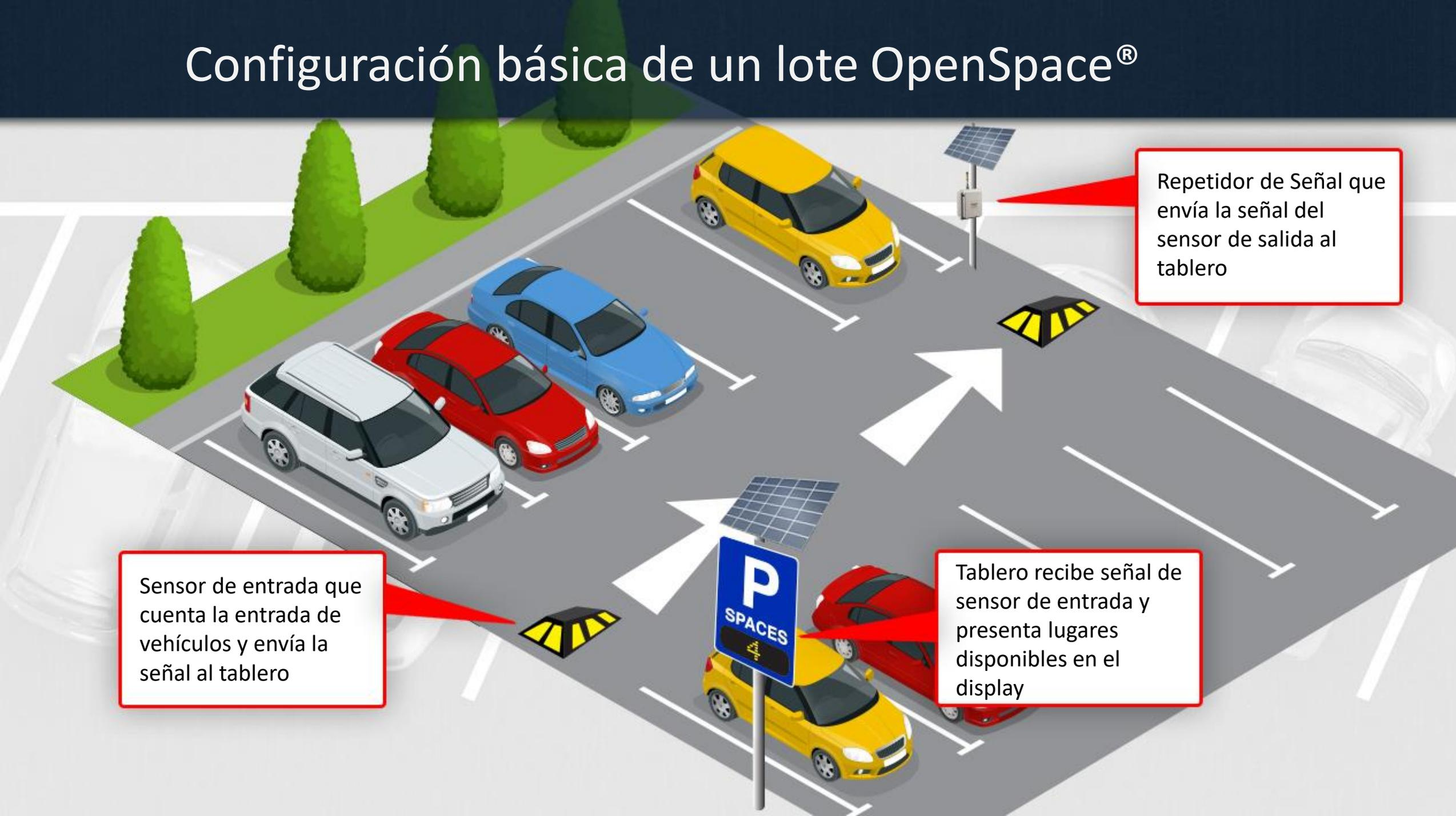
Repetidor de Señal que envía la señal del sensor de salida al tablero
